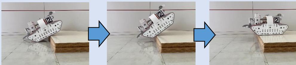
図1.メカナムクローラー台車による段差走破
