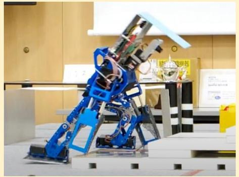
図12. ヒト型レスコンでの階段走破
