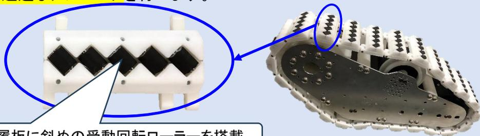
履板に斜めの受動回転ローラーを搭載
