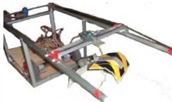
いわゆるUF0キャッチャーを意識したアーム搭載ロボット。水平面内を前後左右方向に移動可能なアームを用い、レスキューダミーの真上までハンドを移動させるそして、多方向から糸で固定されたハンドをレスキューダミーまで降ろしハンドによりレスキューダミーを慎重に把持する。また、ロボット内部に設けたベッドにレスキューダミーを乗せロボットベースまで搬送する。
