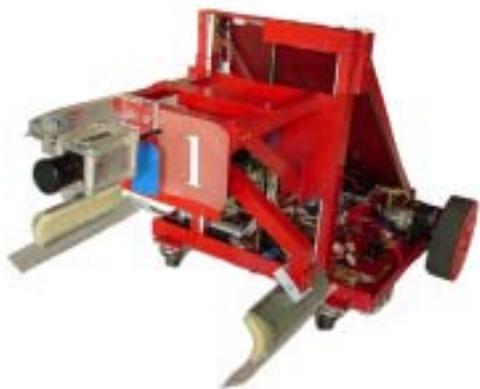
マシン前方に取り付けたアームを駆使して主にレスキューダミーの救出にあたる。マシン上部に取り付けられたCCDカメラは上下左右に回転し、オペレータが望む位置での映像が入手できるようになっている。昨年のプレ大会で活躍した実績が、今年のレスキュー活動を保証する。
